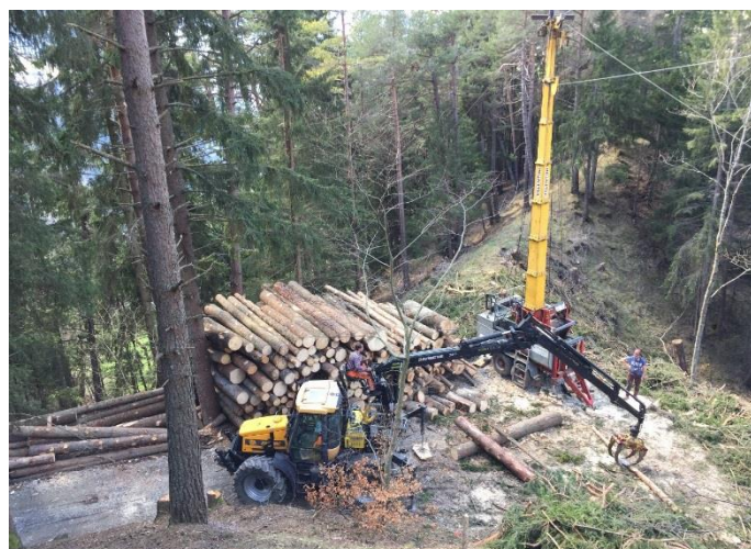
Bild: Seilkran-Bringung im Holzschlag Carschlingg, Castiel
