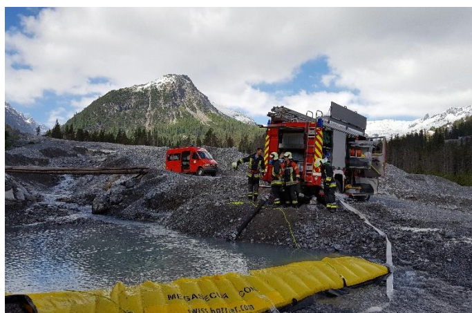
Bild: Wassersperre im Einsatz, hier die grosse Variante
