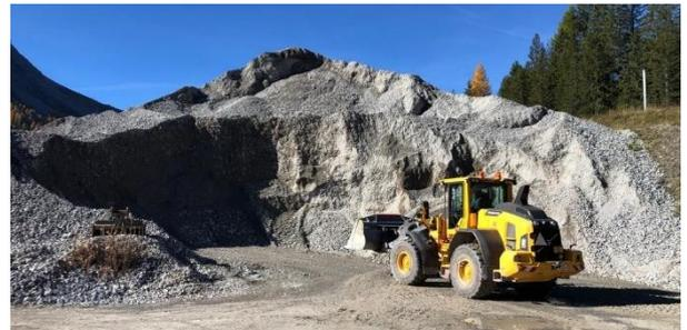
Abbildung 4: Produzierter Mischabbruch (RC-MG) 0/45 nach Norm SN EN 13285
