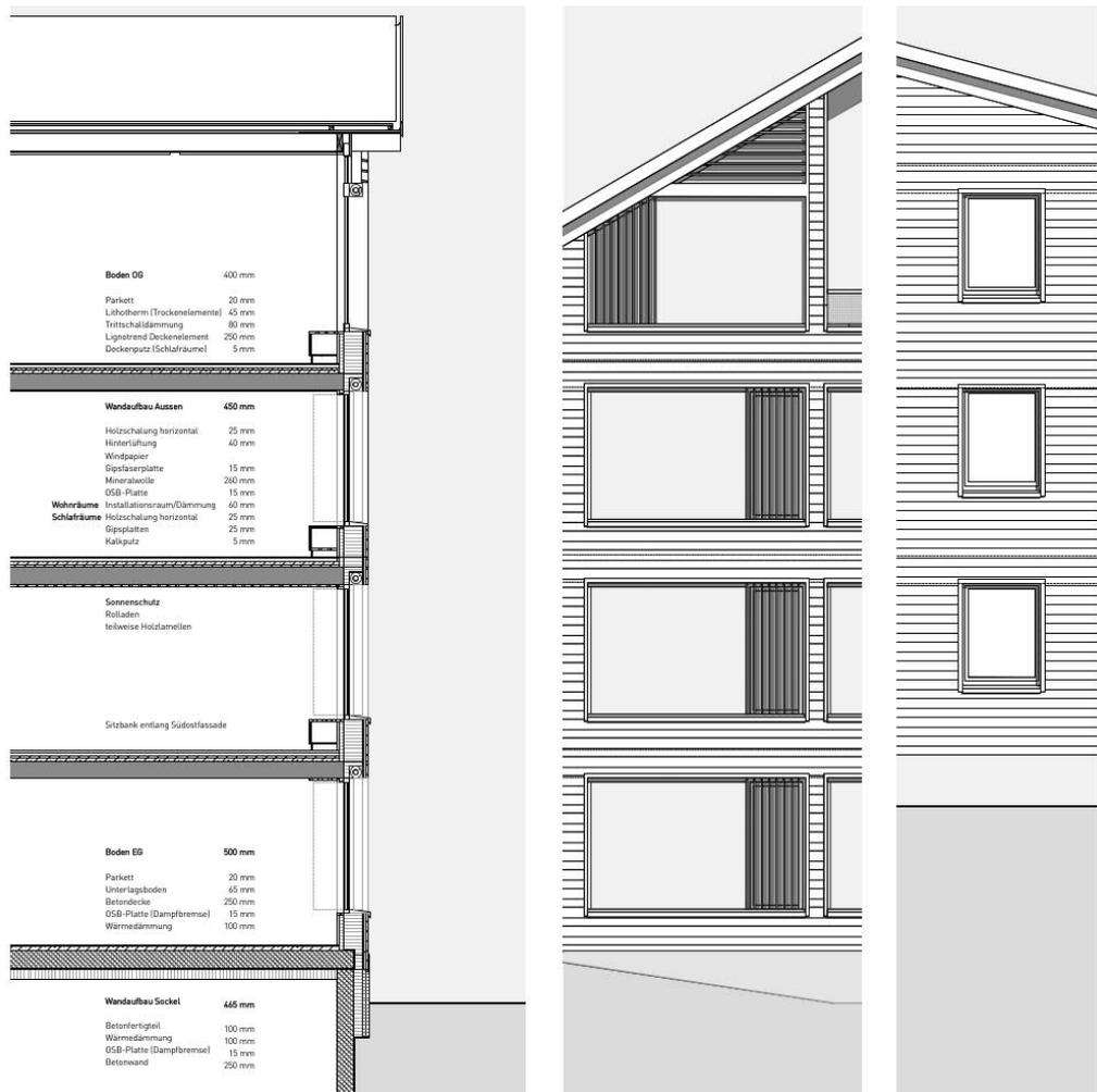
Abb. 38: Fassadenschnitt ZAI (massstabslos)
