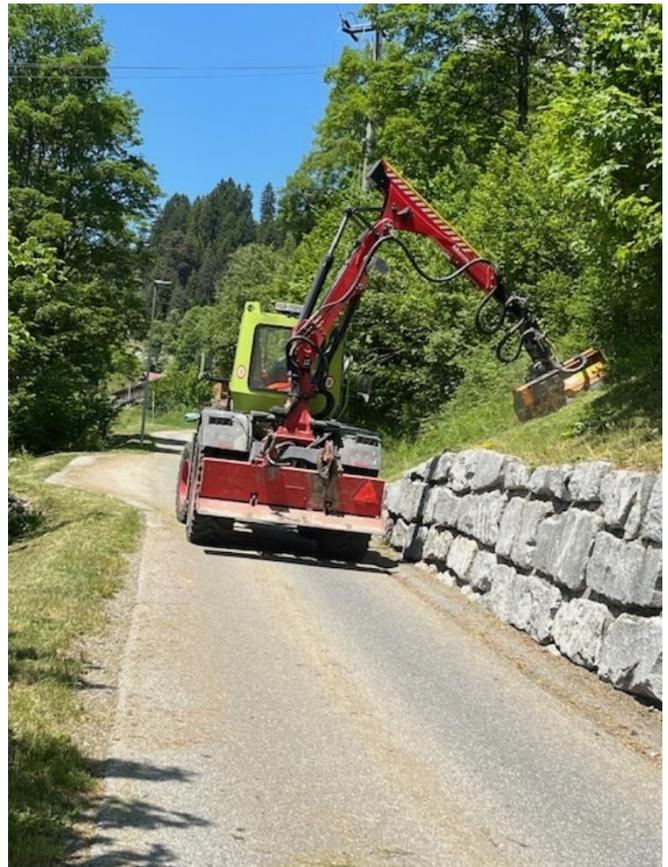
Bild: Mulcharbeiten an Strassenböschungen
