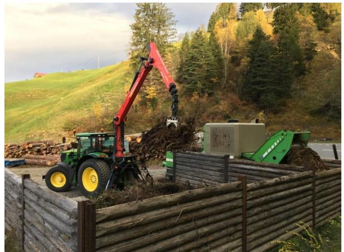
Bild: Schreddern von Ast und Baumschnitt für den Transport
